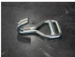
Kuvat 27-28: Säädetty koukku Kuva 29: Säädetty lenkki liinalla ja koukulla
