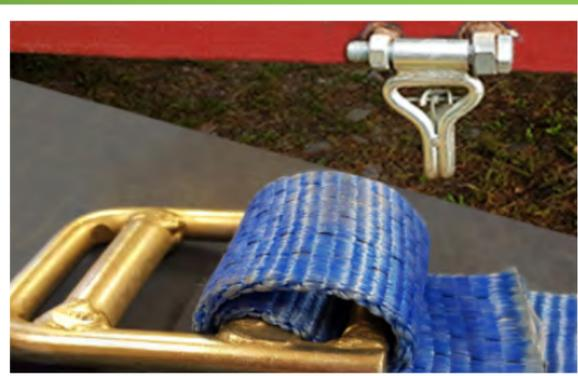
Kuormaliinat kiinnitetään säädettävään lenkkiin, joka kiinnitetään lukittavaan koukkuun. Koukku asennetaan kiinteästi vaunun toiselle puolelle.
