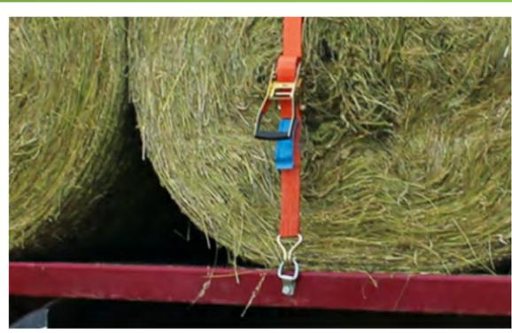
Toiselta puolelta pressu kiinnitetään tavallisilla kiristimillä kiinteästi asennettuihin D-renkaiisiin. Käytännöllinen säilytyslaatikko on saatavilla lisävarusteena.
